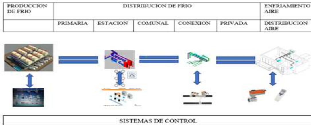
Figura 2. Esquema de componentes de un distrito térmico residencial.
