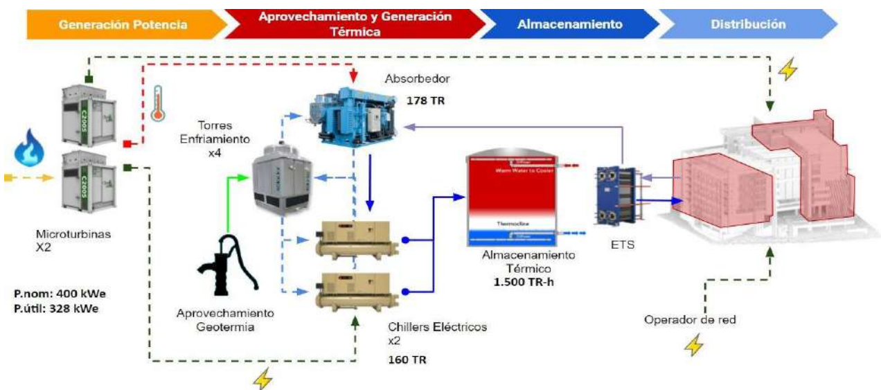
Figura 2: Configuración Distrito Térmico de Frío
