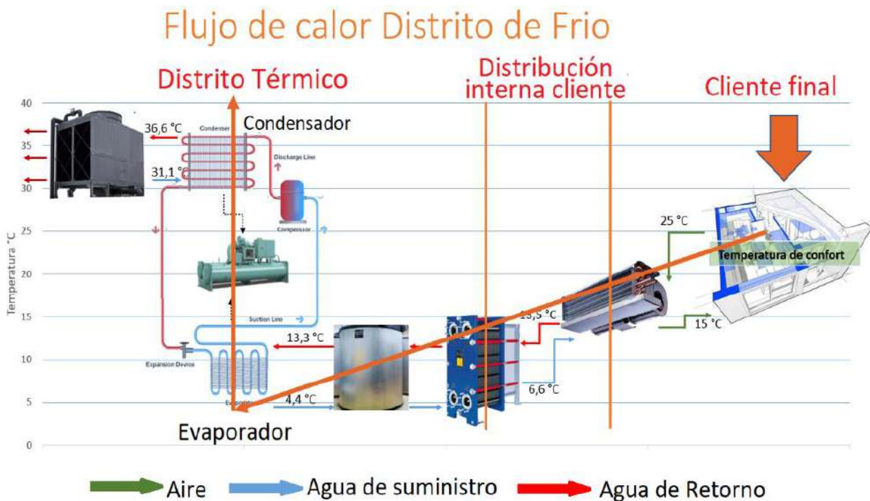
Figura 3. Flujo de calor en un distrito térmico
