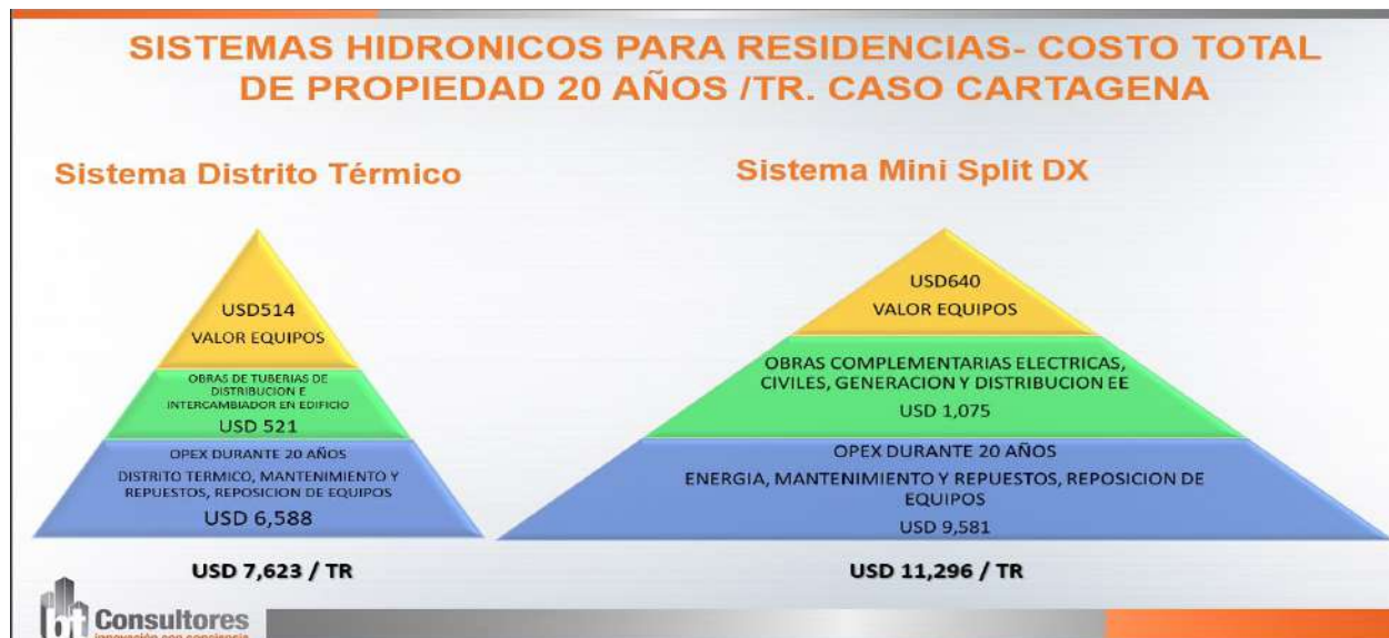
Figura. 1. Comparación costos total de propiedad por TR instalada entre distritos térmicos y sistemas minisplits de expansión directa eléctricos.
